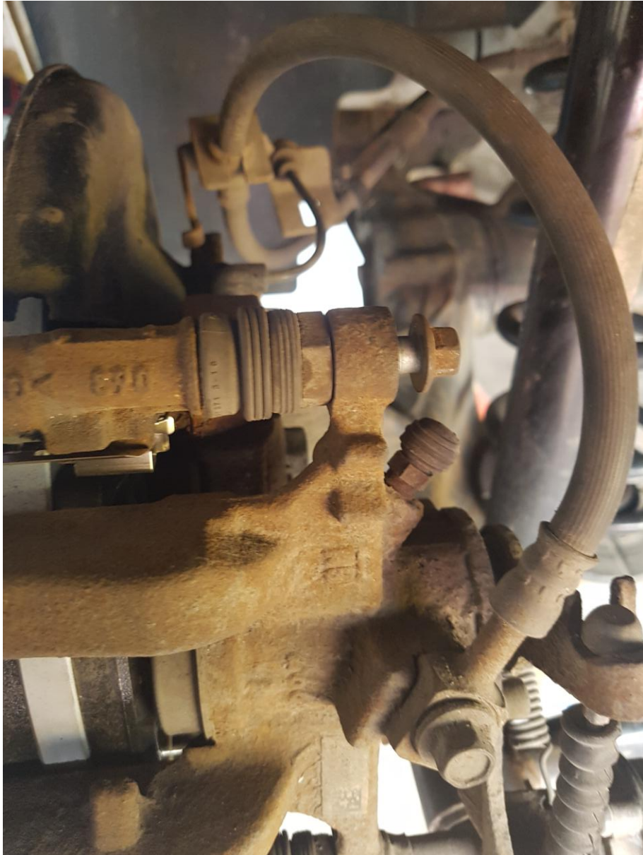
Schraube von der Gleithülse wieder Festziehen.
