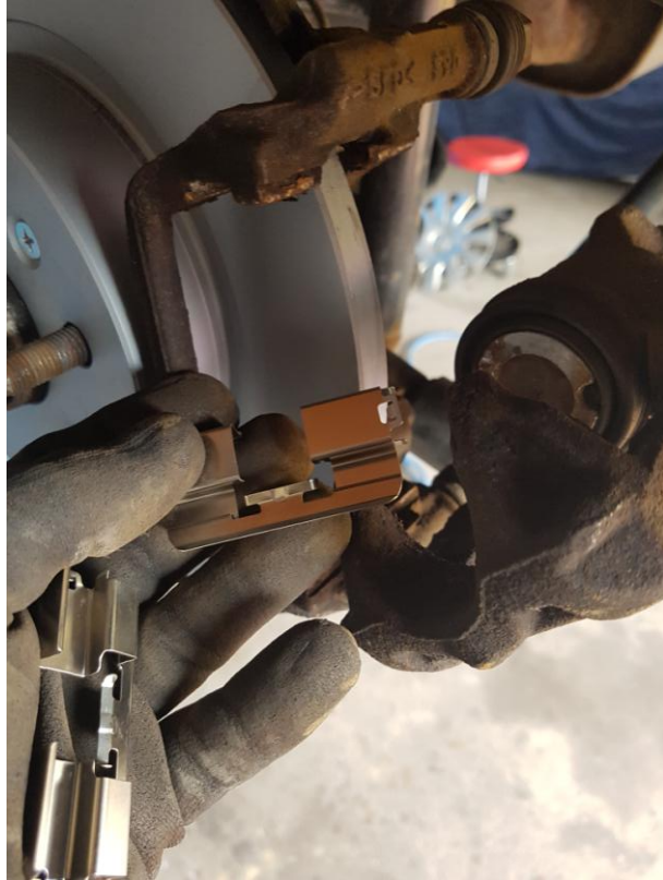
Neue Gleitschienen einsetzen. Sattel vorher grade etwas säubern.
