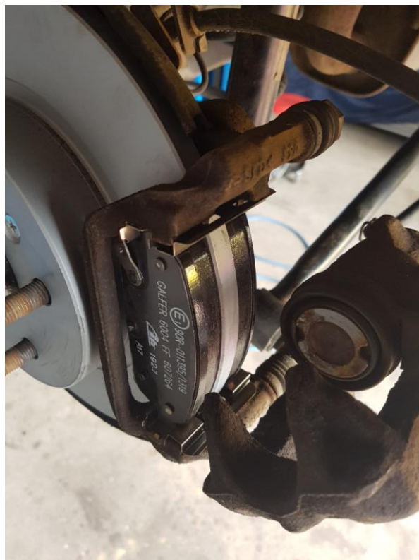
Neue Bremsbeläge können nun eingesetzt werden. (Richtige Seite beachten Belag mit den Noppen ist Kolbenseite in diesem Fall)
